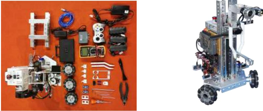
图1 移动机器人套件及整机
