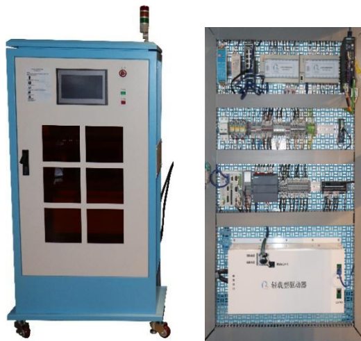
图 23 控制系统安装平台（仅供参考）
