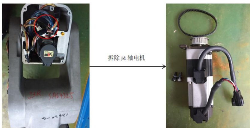
图9 拆卸 J4 轴电机示意图
